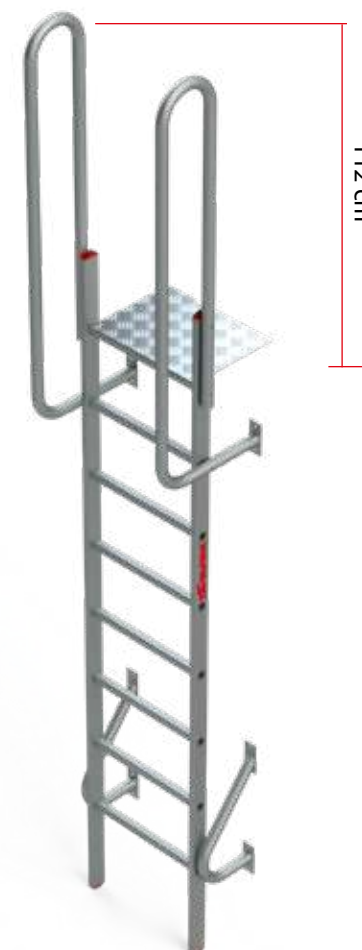
Kwadratowy szczebel 30x30 mm, szerokość 52 cm. Square step 30x30 mm, 52 cm wide.
