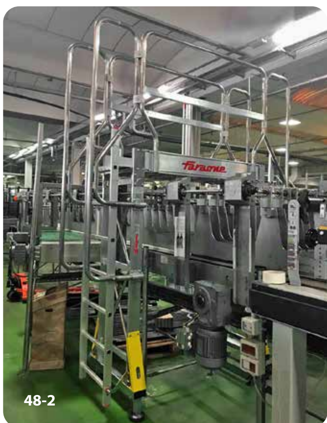
Platforma w kształcie litery L z podwójnym dostępem. Z-shaped ladder with painted lateral sides.
