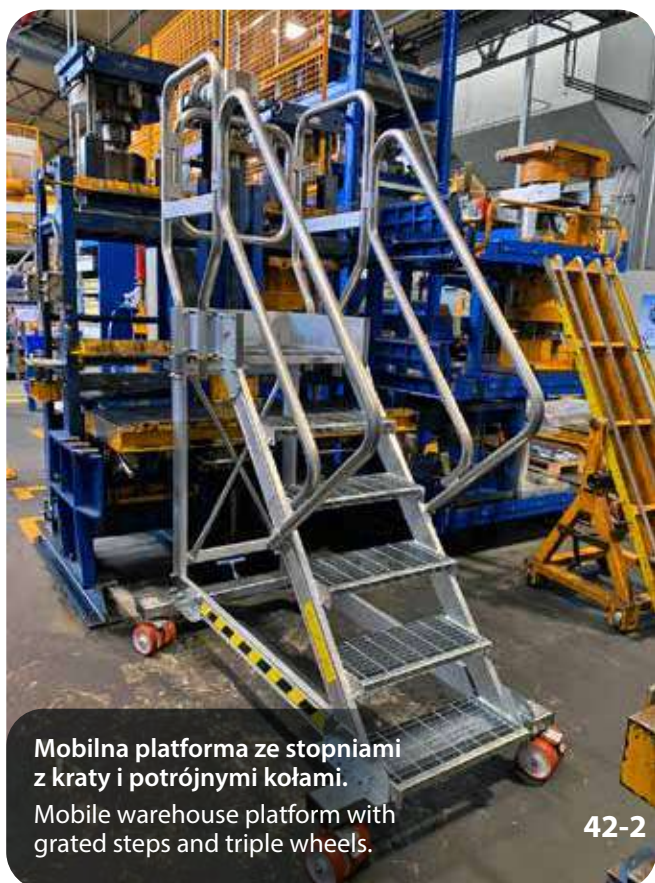
Mobilna platforma magazynowa z bocznym dostępem do miejsca pracy i podstawą Sicur-Stop. Mobile warehouse platform with access gate, side landing and Sicur-Stop base.
