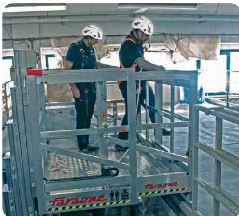
Platforma z zejściem na wysokości dla 2 operatorów. Special Elevah for two people to exit the platform at height.
