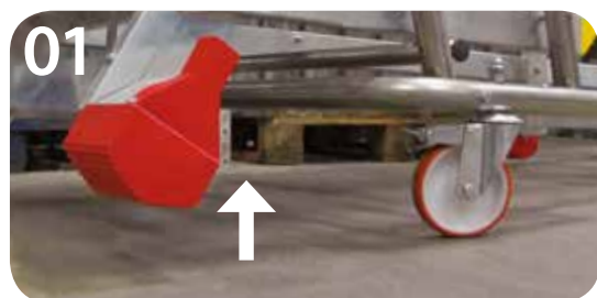
01. PODSTAWA STABILIZUJĄCA PODNIESIONA 1. LIFTED STABILISING BASE
