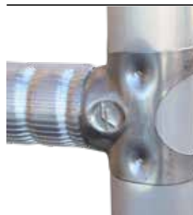
Nowe złącze ze stali nierdzewnej bez spawów zwiększa o 50% sztywność wieży jezdnej i podwaja jego żywotność.
