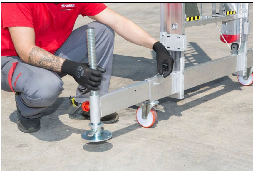
Rys.2: Blokowanie podstaw stabilizujących
