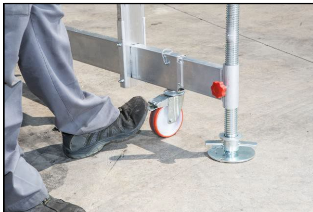
Rys.10: Blokowanie kół za pomocą hamulca
