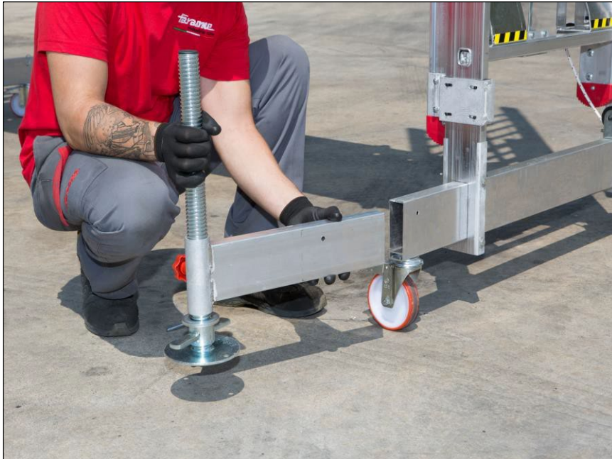
Rys.1: Wsuwanie podstaw stabilizujących
