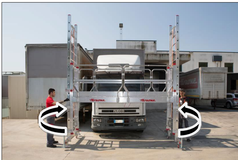
Rys. 11: Podnoszenie podestu roboczego
