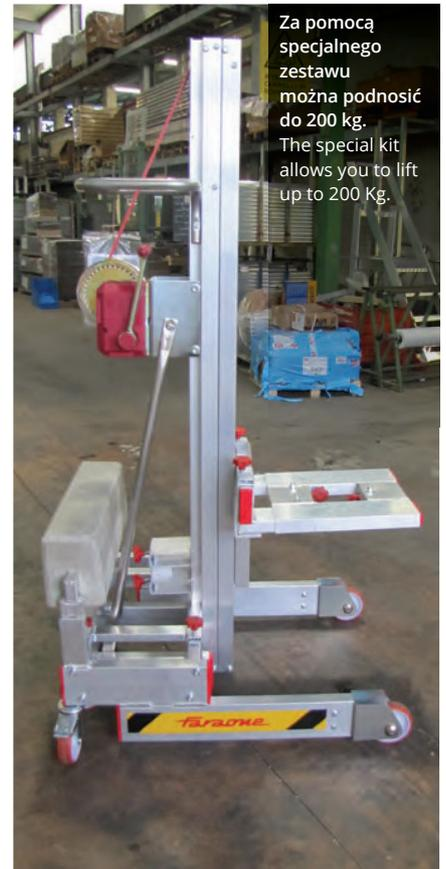
Za pomocą specjalnego zestawu można podnieść do 200 kg. The special kit allows you to lift up to 200 Kg.
