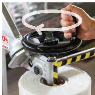
Obracając pokrętko mocuje się belę, przeznaczoną do przemieszczenia.
